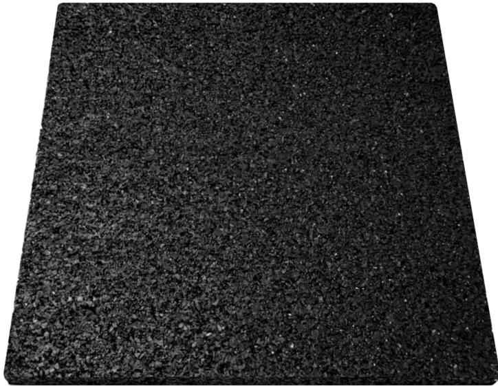
Die **Bautenschutzmatten** bietet optimalen Schutz für Flachdächer, Bauwerke und Dachhaut. Mit einer Materialstärke von 12 mm gewährleistet sie eine effektive Wasserableitung und schützt vor mechanischen Einflüssen. Diese Unterlegmatte ist ideal für die Anwendung auf Flachdächern aus Bitumen, Beton, Holz oder Asphalt und entspricht der anerkannten Schutzschicht nach DIN 18195, Teil 10.
